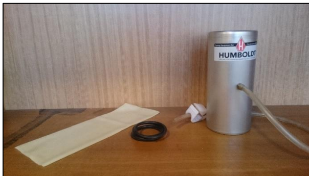
Figura J-6: Membrana, expansor de membrana y o-rings.
