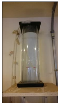
Figura J-14: Estanque de agua desaireada.
