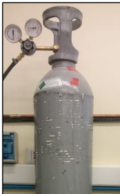
Figura J-10: Tanque con CO 2 y flujómetro N°1.
