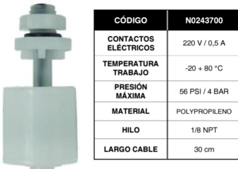
Figura 6.3 Switch de nivel seleccionado e información técnica
