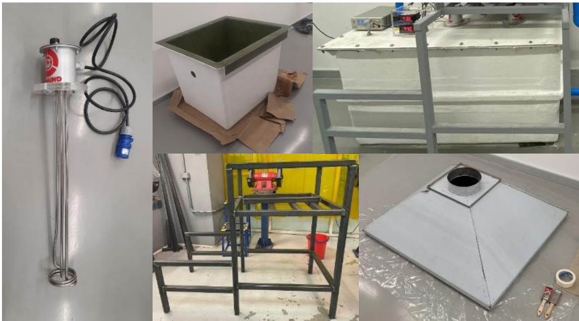
Figura 8.1 De arriba a abajo e izquierda a derecha: calefactor, celda electrolítica, estanque de almacenamiento, estructura, campana de extracción.
