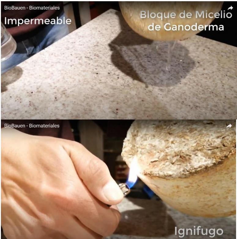
Figura 3 - 20. Pruebas de impermeabilidad y resistencia (capturas de video de concurso Copec-UC)
