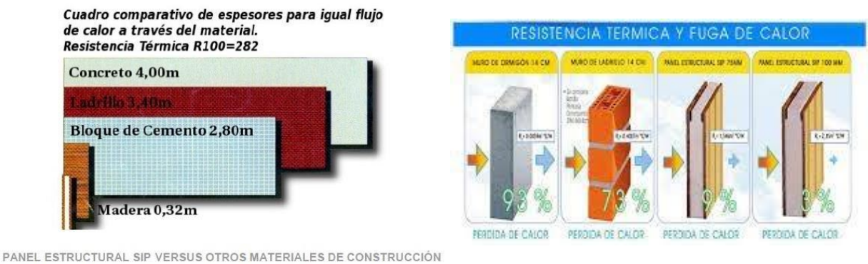
Figura 4 - 7. Aislación térmica de distintos materiales
