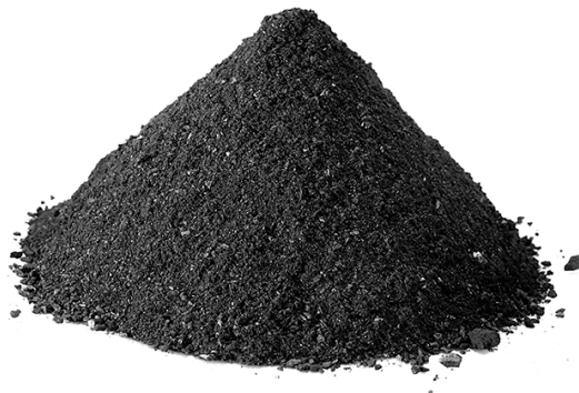
Figura 3.7: Char de la pirólisis de neumáticos (Waste2oil, 2021)
