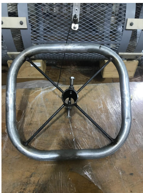
Tubo contenedor de conductor mas anillo corona vista de frente (Elaboración propia).
