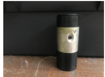
Figura 3.5: Equipo de calibración del sonómetro (elaboración propia).
