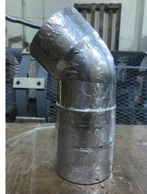
Codo de PVC, unión entre elevador de tensión, el conductor y el divisor capacitivo (Elaboración propia).
