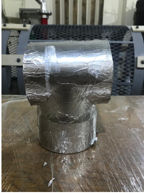
Codo de PVC, unión entre el conductor y el elevador de tensión (Elaboración propia).
