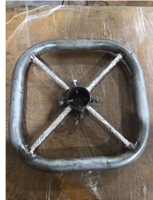
Anillo corona desmontable (Elaboración propia).
