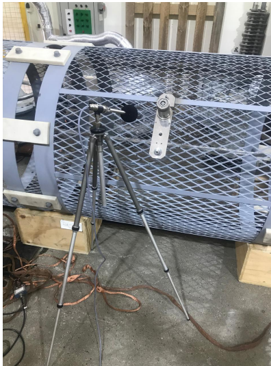
Figura 3.4: Micrófono conectado al sonómetro (elaboración propia).
