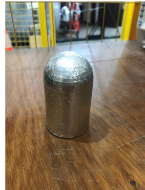
Tapa de filamento 3d recubierta con aluminio (Elaboración propia).
