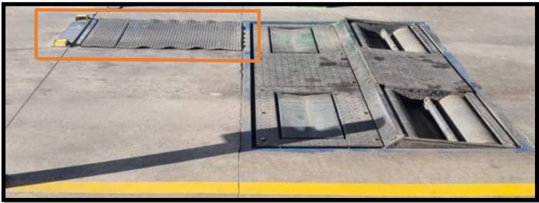
Figura 5. Conjunto de equipos de PRT destacado Alineador al paso Fuente: Elaboración propia
