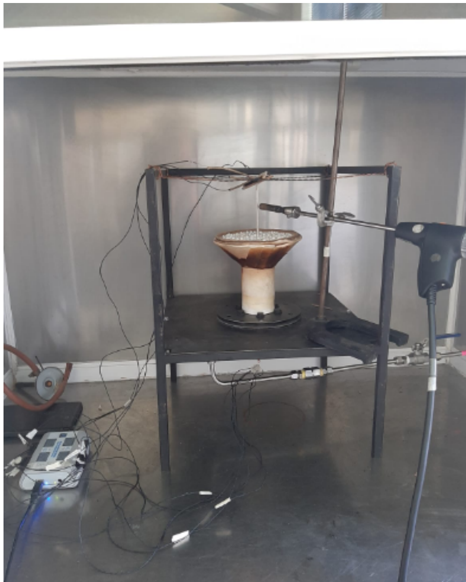
Figura 3.19: Quemador con los sistemas de medición de temperatura y emisiones.
