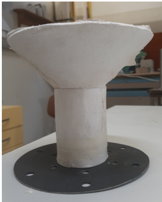
Figura 3.8: Quemador con aislación externa de fibra cerámica.
