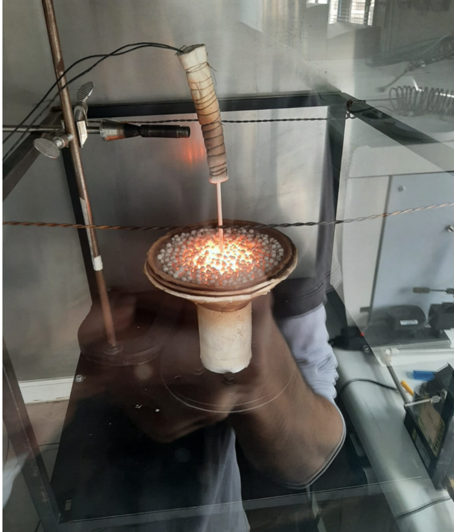
Figura 5.3: Reactor divergente de medio poroso inerte en operación.
