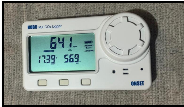
Ilustración 1. sensor térmico (HOBO mx c02 loggers
