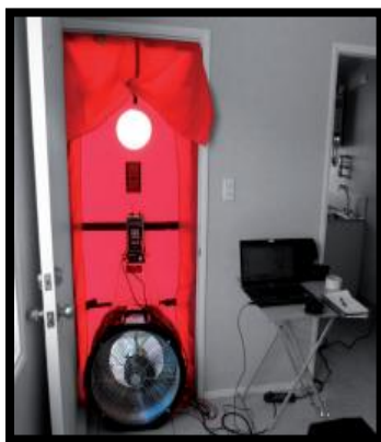
Ilustración 17. Equipo blower door de un ventilador
