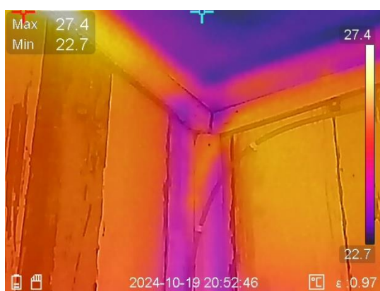
Ilustración 42. fotografía térmica de conexión muro y cielo raso segundo piso de la vivienda
