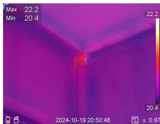
Ilustración 42. fotografía térmica de conexión muro y cielo raso segundo piso de la vivienda
