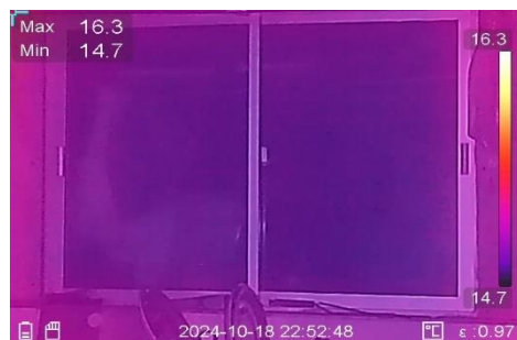
Ilustración 34. fotografía térmica de puerta de acceso ingreso a sector cocina
