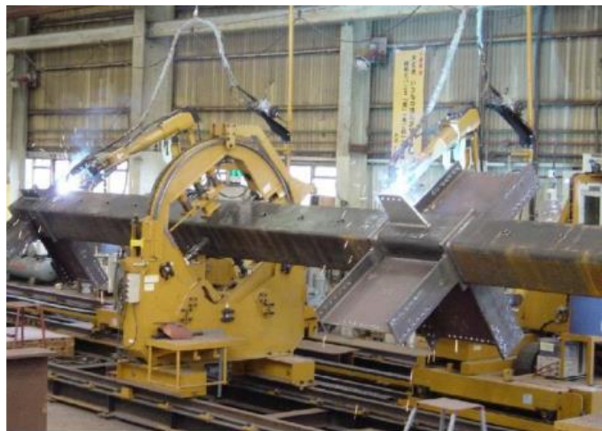
Figura 3-5. Robots de soldadura Automáticos utilizados en Japón [Futamura. 2017].
