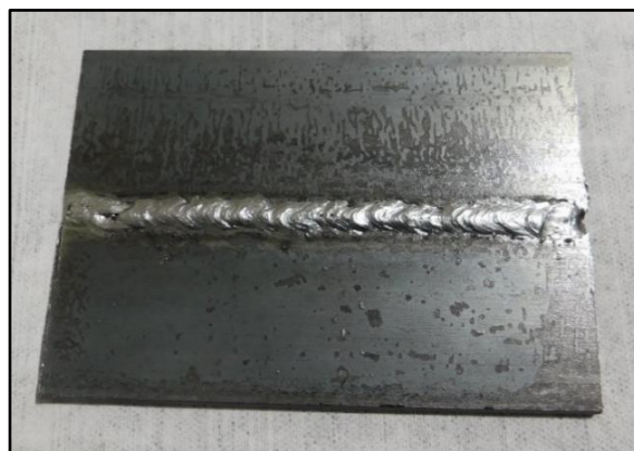
Ilustración 1-9 "Probeta limpia de exceso de penetrante"
