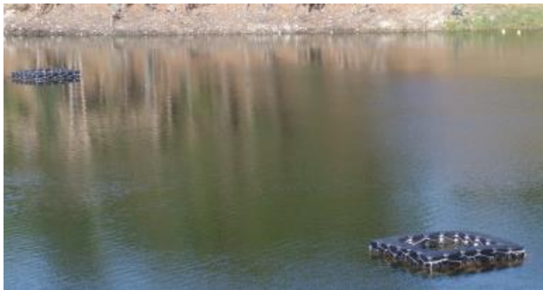
Figura 4.5 Dispositivos para el tratamiento (limnocorrales)viruta de eucalipto en el embalse de "A Baxe", Caldas de Reis
