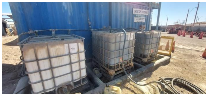
Figura 29. Estanques de almacenamiento de soluciones lixiviantes (ISO).
