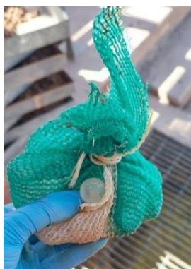
Figura 57. Malla filtrante con esferas de polipropileno. Prueba de columnas.
