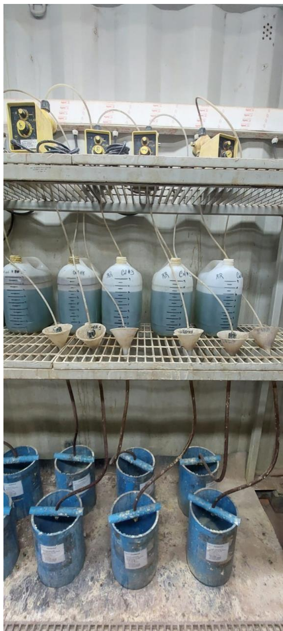
Figura 27. Sistema de alimentación a columnas.
