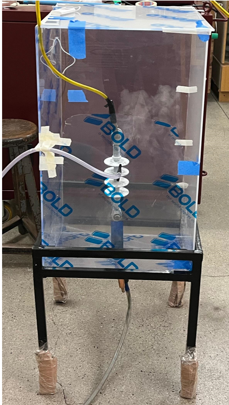
Figura 67: Fotografía de cámara de humedad.
