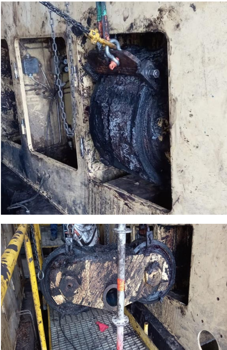
Sistema de lubricación de Bogies en mal estado
