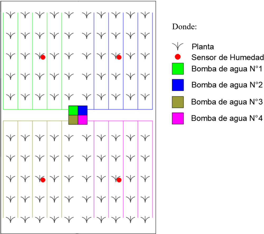
Figura 3.10: Disposición y alcance de cada sector de riego.
