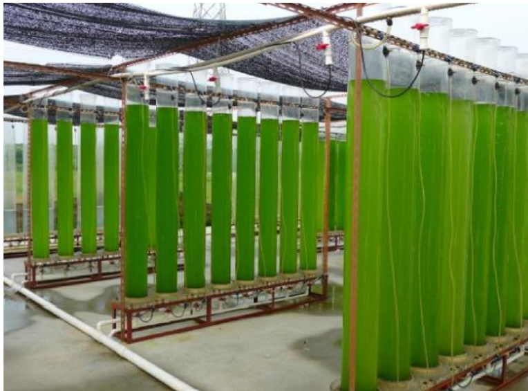
Figura 3.5 Fotobiorreactor tubular de columna vertical con cultivo de Chlorella zofingiensis . Adaptado de [15].
