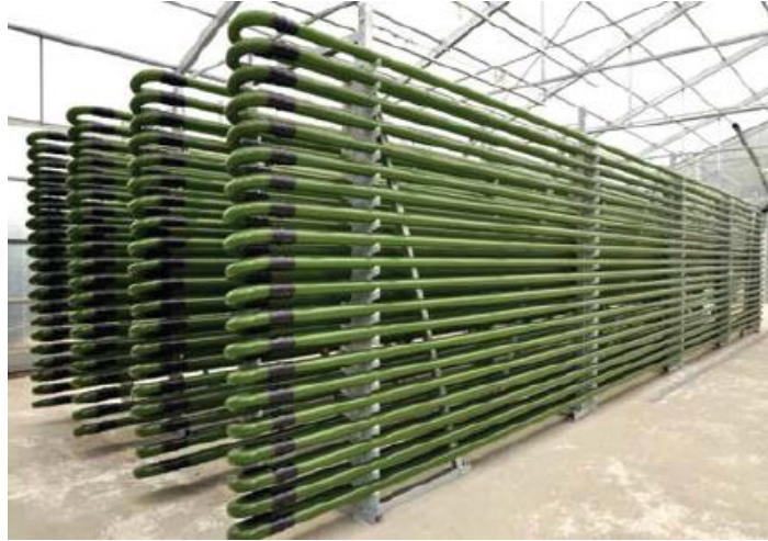
Figura 3.4 Fotobiorreactor tubular horizontal. Adaptado de [13].
