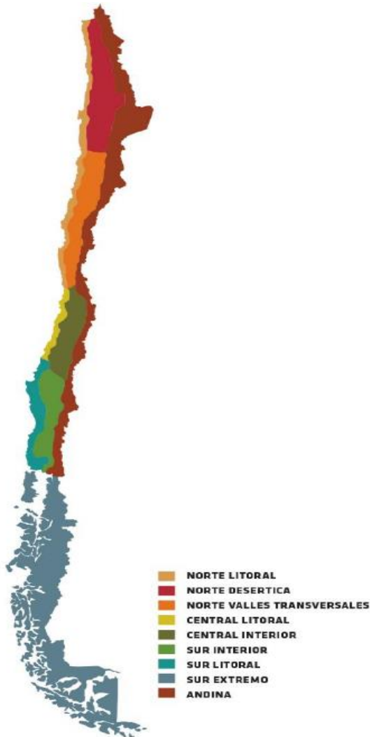
Figura 1-4 Mapa de climatización según Nch 1079-2008 Fuente: Guía de Diseño para la Eficiencia Energética en la Vivienda Social
