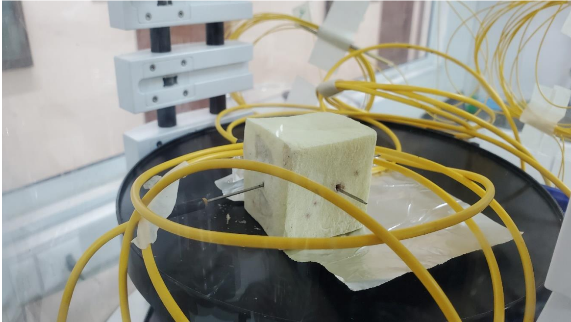
Figura 17: Fibra FBG instalada en el equipo de liofilización.
