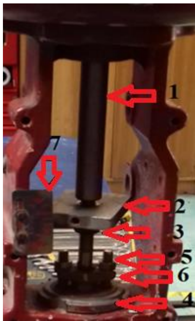
Ilustración 4-4-1: Orden de desarme del actuador.
