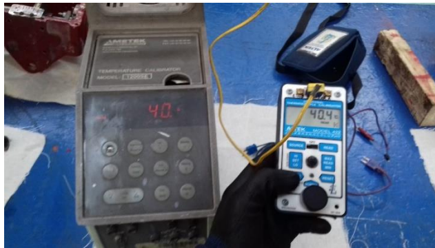
Ilustración 9-8: Verificación de estado del TC con 35°C.
