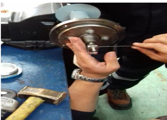
Ilustración 3-16: Apriete de sensor.
