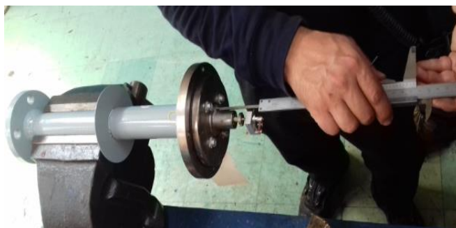
Ilustración 3-15: Ajuste de sensor con pie de metro.
