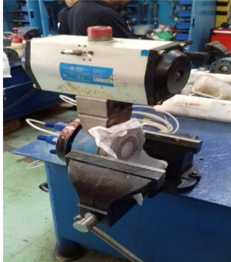
Ilustración 5-3-3: Prueba de filtración de la válvula.
