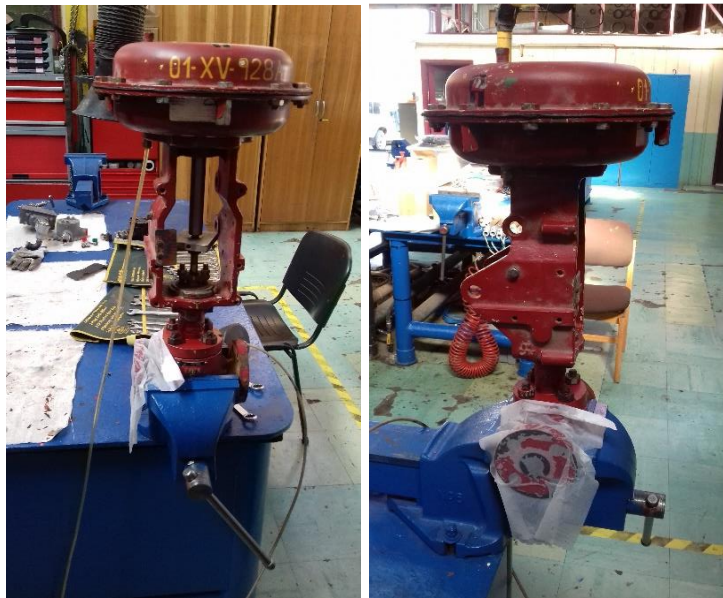
Ilustración 4-3-2: Prueba de respuesta de la válvula y filtración.
