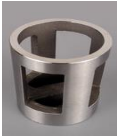
Ilustración 4-5-1: Jaula de válvula en buenas condiciones.
