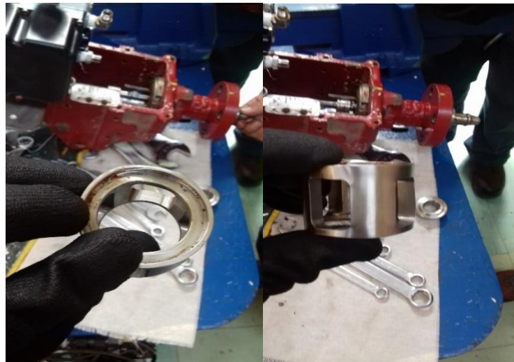
Ilustración 4-5: Jaula de válvula dañada.
