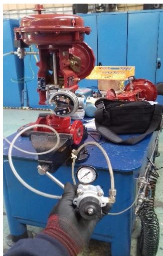
Ilustración 8-5: Conexión para generar la presión de entrada.
