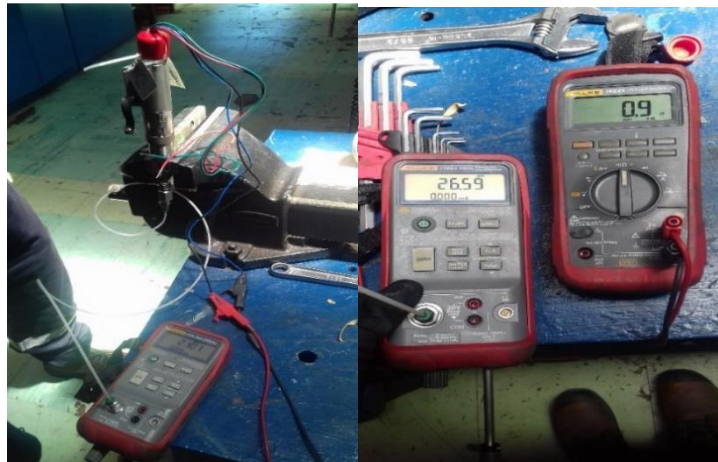
Ilustración 6-4: Conexión para calibrar en taller.
