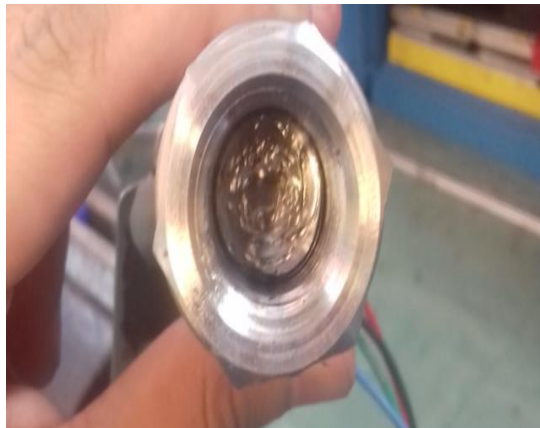
Ilustración 6-2: Switch con problemas de filtración.
