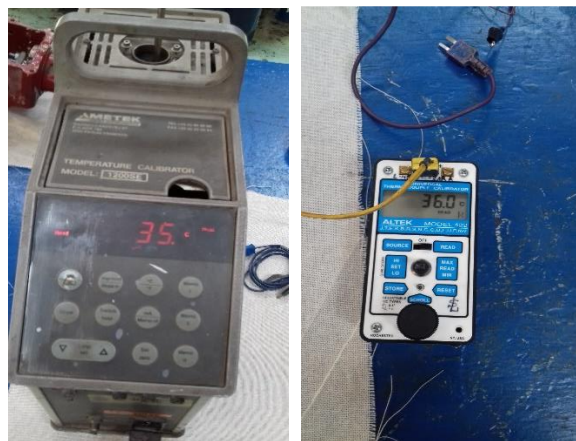
Ilustración 9-8: Verificación de estado del TC con 35°C.
