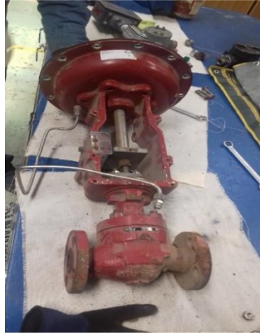
Ilustración 4-3: Condición de llegada de la válvula.
