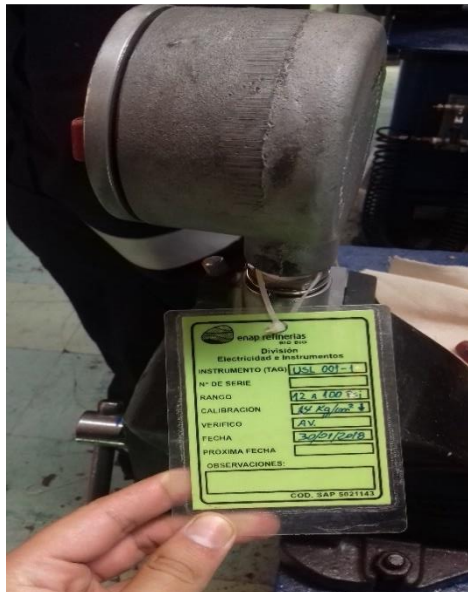
Ilustración 6-5: Instrumento en condiciones de ser instalado.
