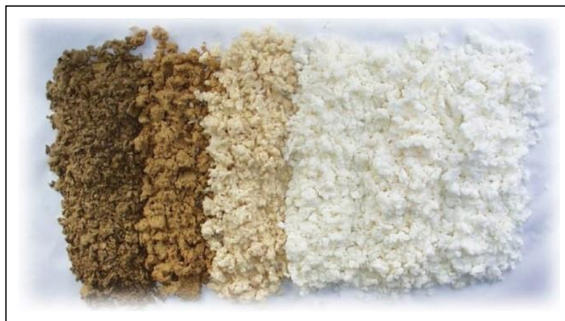
Figura 1-5. Etapas del blanqueo de Celulosa
