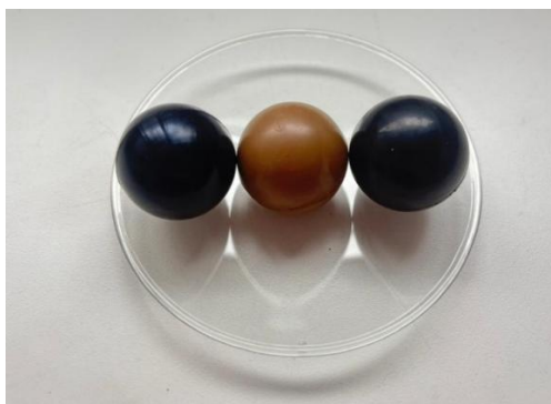
Figura 3.1 Muestra de elastómeros NBR, FKM y EPDM con diámetro de 30 mm.
