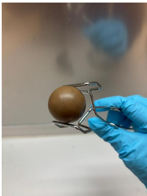
Figura 4.20 Muestra de FKM de 30 mm posterior a la sorción de hidrógeno con desgaste superficial.
