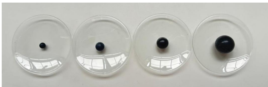
Figura 3.2 Muestras de NBR de 10, 15, 20 y 30 mm de diámetro.
