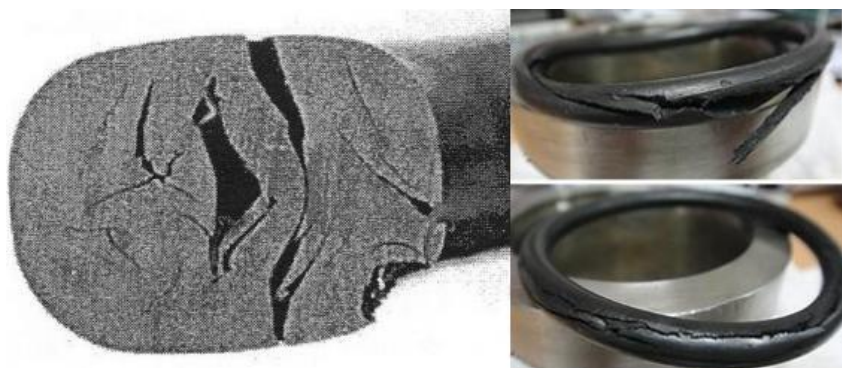
Figura 2.10 Sellos tipo O-ring posterior a un evento de descompresión explosiva.
