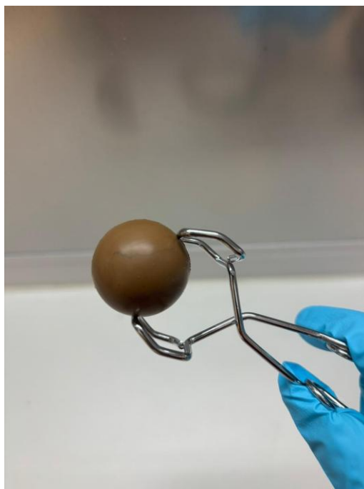
Figura 4.19 Muestra de FKM de 30 mm posterior a la sorción de hidrógeno con grieta superficial.
