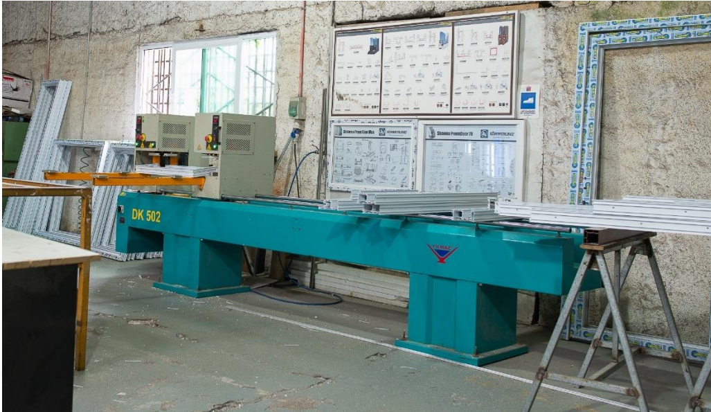
IX.- Termofucionadora, tiene un lado móvil ajustable dependiendo de las dimensiones del marco solicitado
