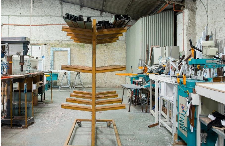
VIII.- A la derecha se encuentra la máquina de desagado, en la izquierda se puede observar la maquina utilizada para la perforación del PVC para luego insertar tornillos de refuerzo
