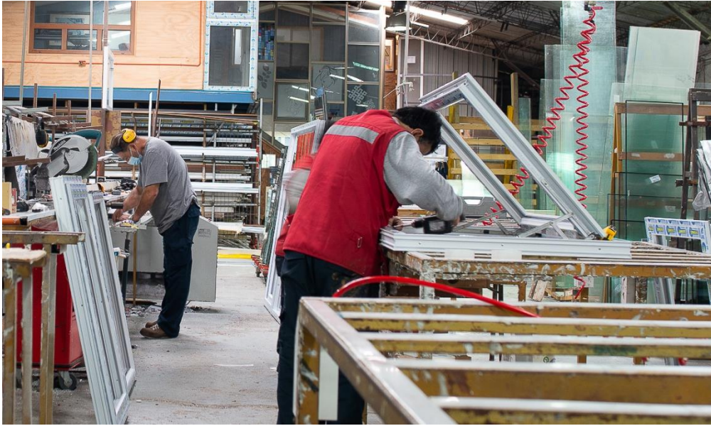
X.- Maestros en el proceso de montaje de herraje y accesorios de la ventana
