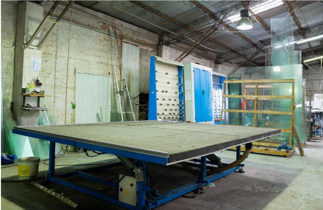
VI.- En la imagen se muestra mesa de corte de cristal, atrás e puede ver atriles, en el fondo ,lavadora de cristal utilizada para la fabricación de termo panel
