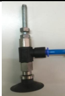
Imagen 2: foto ventosa y adaptador de agarre en 90°.
