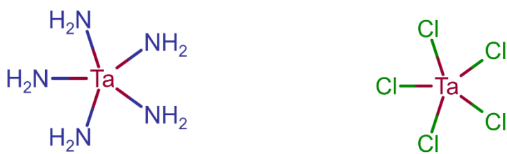
Figura 13: Estructuras moleculares de PDMAT y TaCl 5
