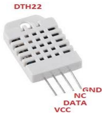
Figura 2-3. Sensor de temperatura y humedad DHT22
