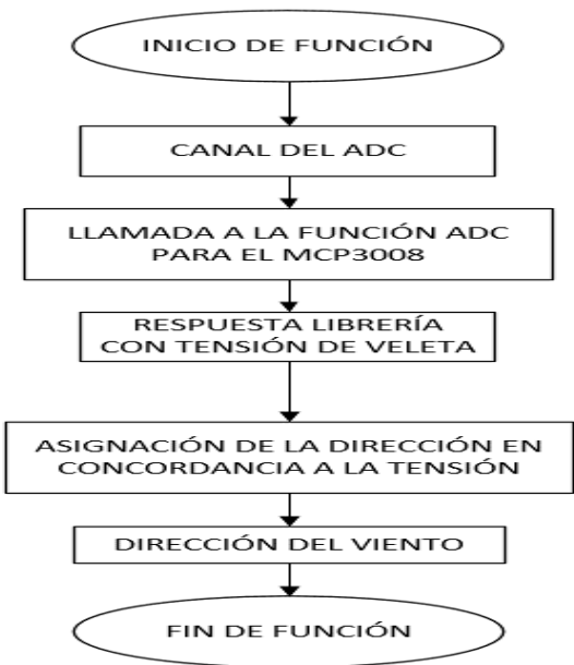
Figura 3-4. Diagrama de bloques función de la dirección del viento
