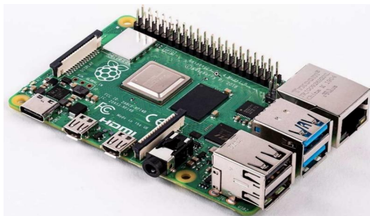
Figura 1-3. Raspberry PI-4 modelo B
