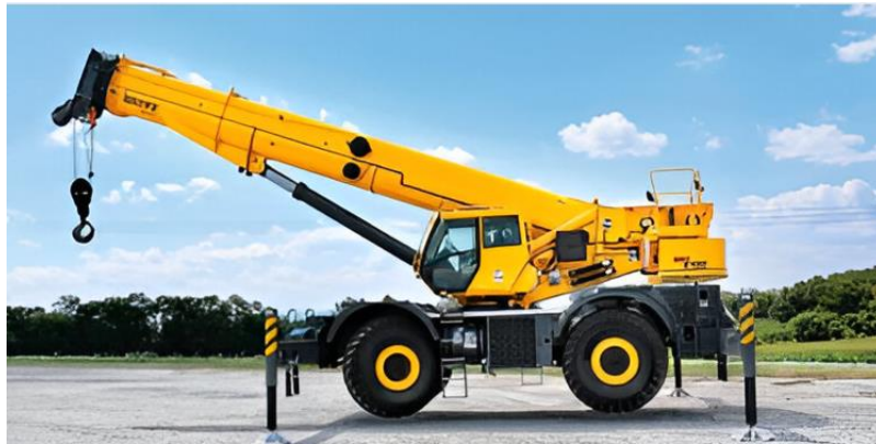
Figura 2-1. Modelo de Grúa Rough Terrain (RT)
