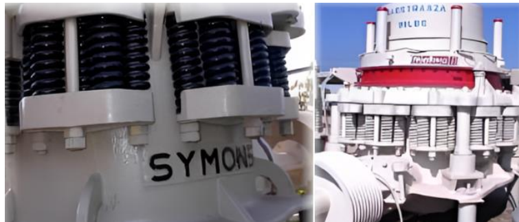
Figura 1-7. Chancador Symons reacondicionado por Maestranza Wilde
