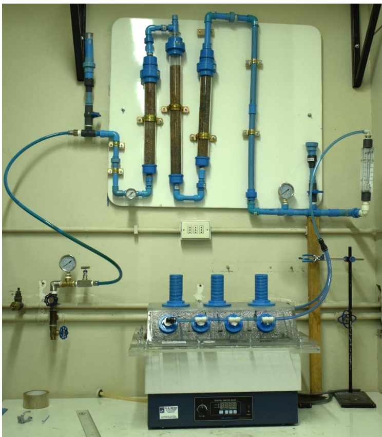
Figura 19: Sistema implementado de evaporación de salmueras mediante burbujas secas
