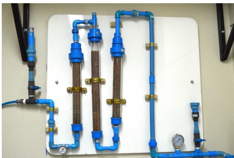
Figura 17: Sistema de adsorción con sensores de presión (P-101, P-102)
