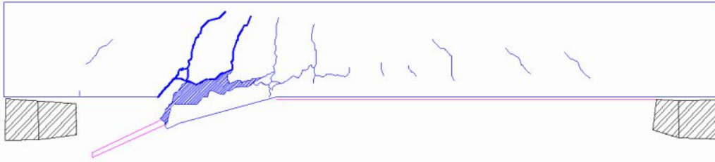
Figura 3.3. Delaminación del FRP que se extiende hacia el centro. 15
