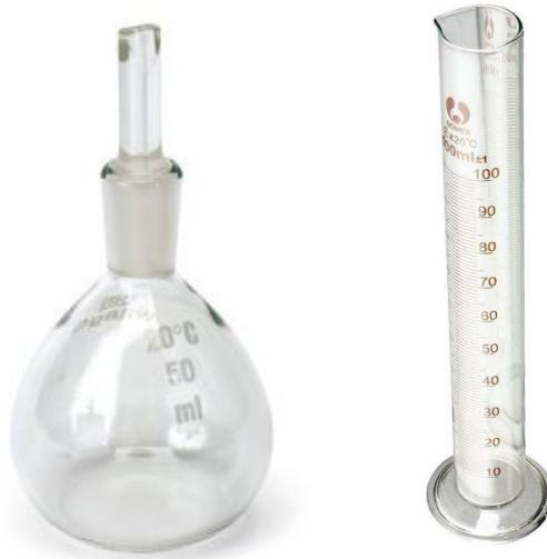
Figura 2-2: Picnómetro y probeta graduada para determinar la densidad de las partículas
