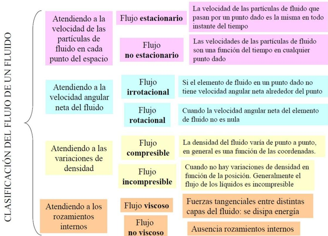
Figura 2-1: Clasificación del flujo de fluido
