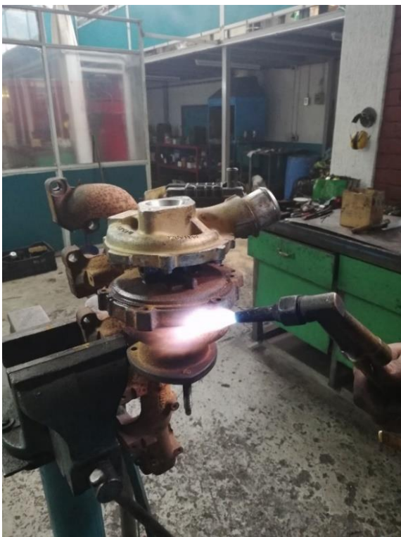
Figura 3-6: Turbo sometido a calor
