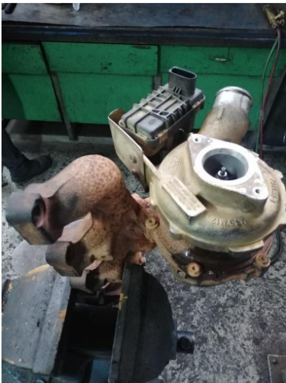
Figura 3-5: Turbo montado en prensa hidráulica
