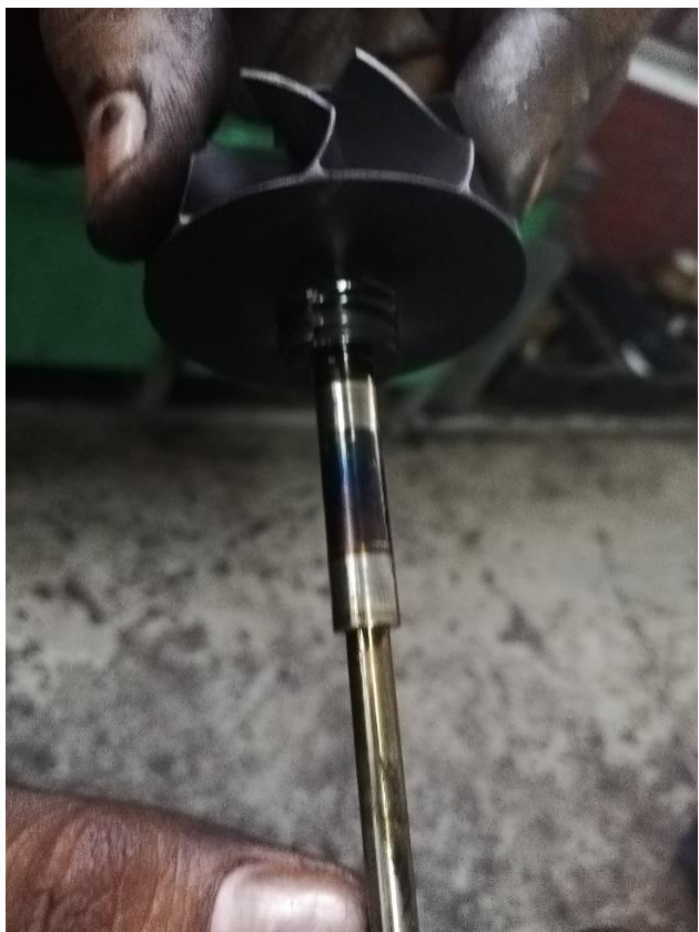
Figura 3-16: Eje coaxial azulado
