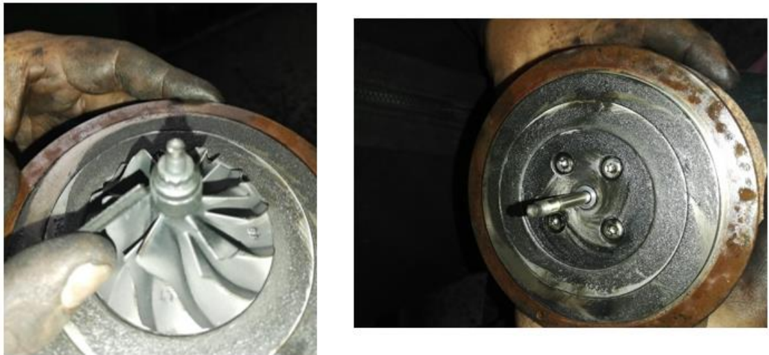
Figura 3-15: Aspas del eje y pernos de sujeción
