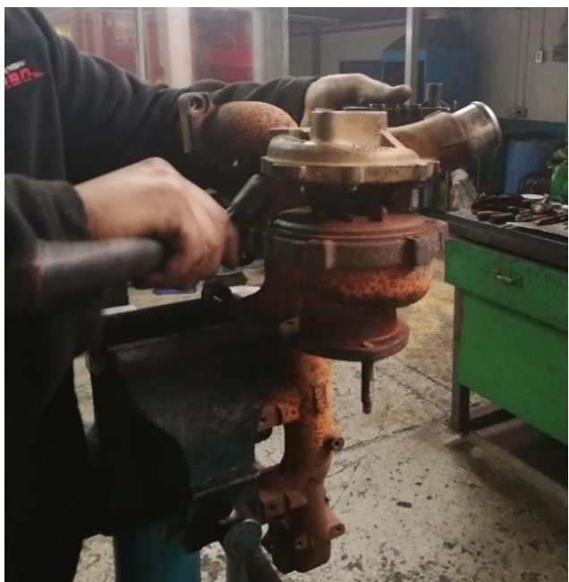
Figura 3-7: Separando carcasa de escape
