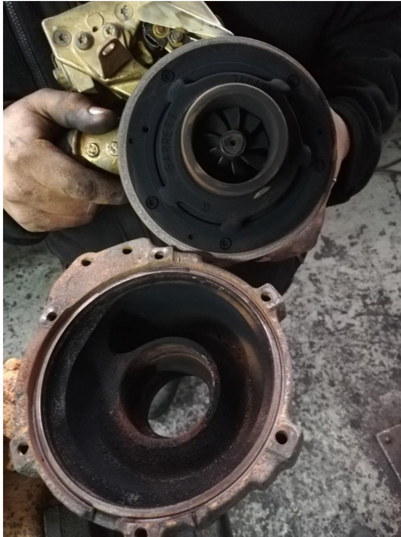
Figura 4-4: Carbonilla en carcasa
