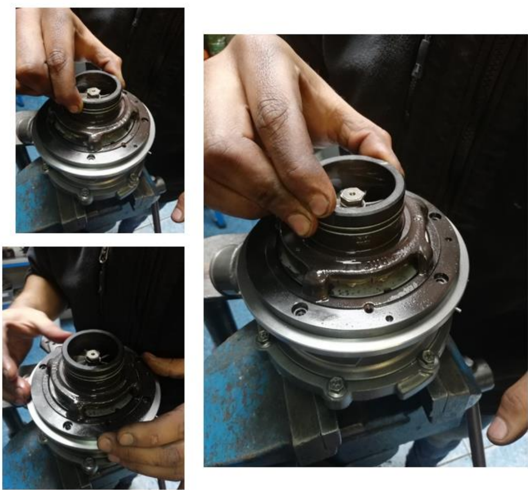
Figura 3-31: Posicionando y montando carcasa geometría
