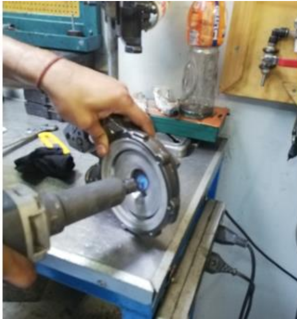
Figura 3-26: Proceso de pulido
