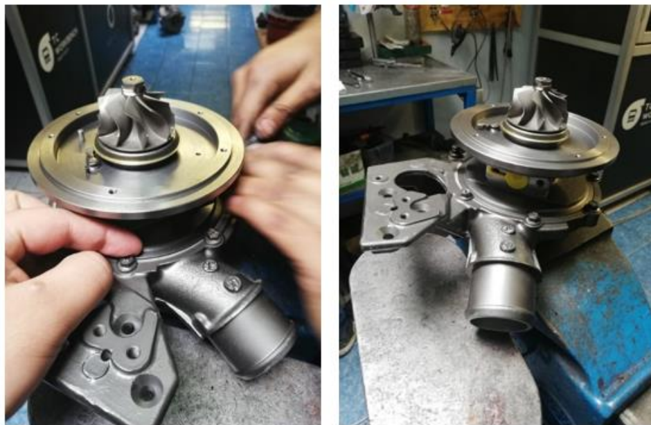
Figura 3-27: proceso montaje en prensa hidráulica
