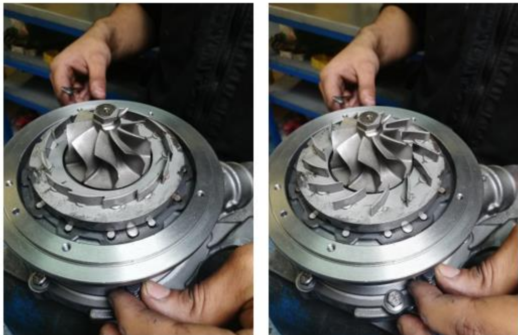
Figura 3-29: Revisión geometría variable
