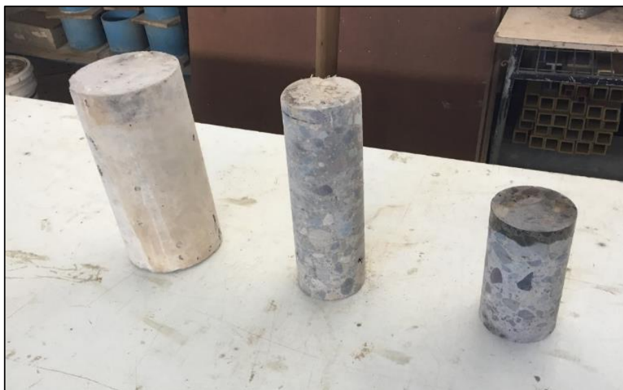
Figura 18: Proceso de probetas para obtener núcleos perforados a ensayar [elaboración propia].
