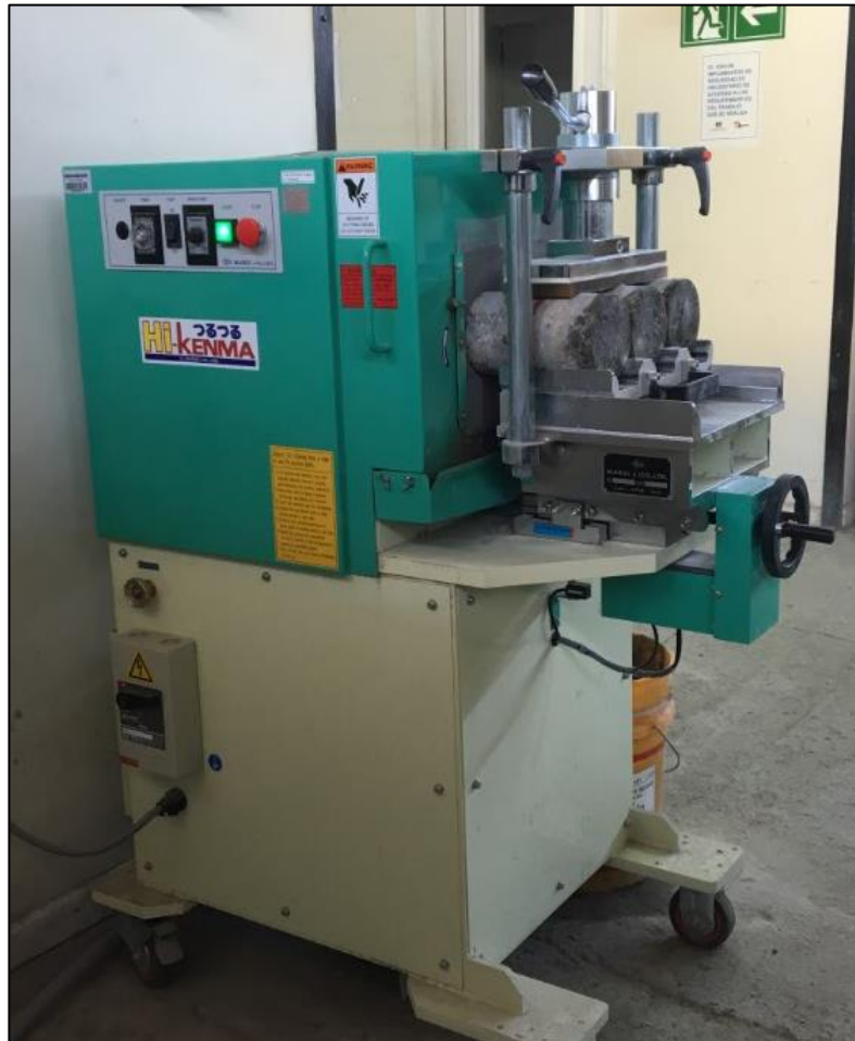
Figura 14: Máquina Rectificadora de Hormigón Automática [Existente en LEMCO].
