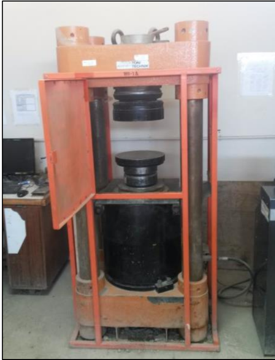
Figura 15: Prensa de Ensayo utilizada para la Compresión Cilíndrica [Existente en LEMCO].
