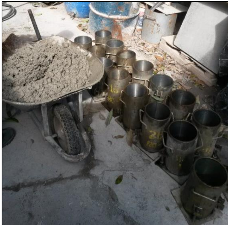
Figura 12: Preparación de moldes en terreno [elaboración propia].
