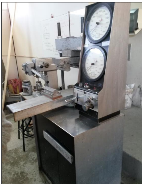
Figura 17: Prensa de Ensayo utilizada para la Flexotracción [Existente en LEMCO].
