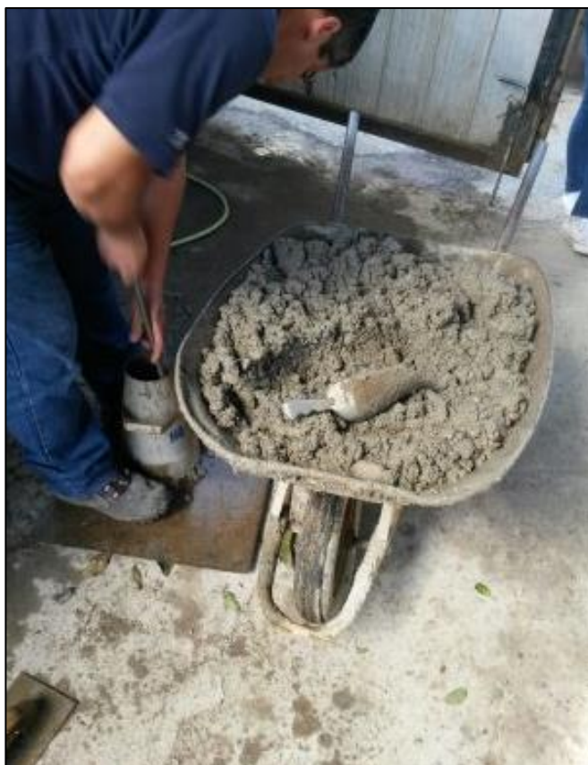
Figura 11: Asentamiento del cono de Abrams [elaboración propia].
