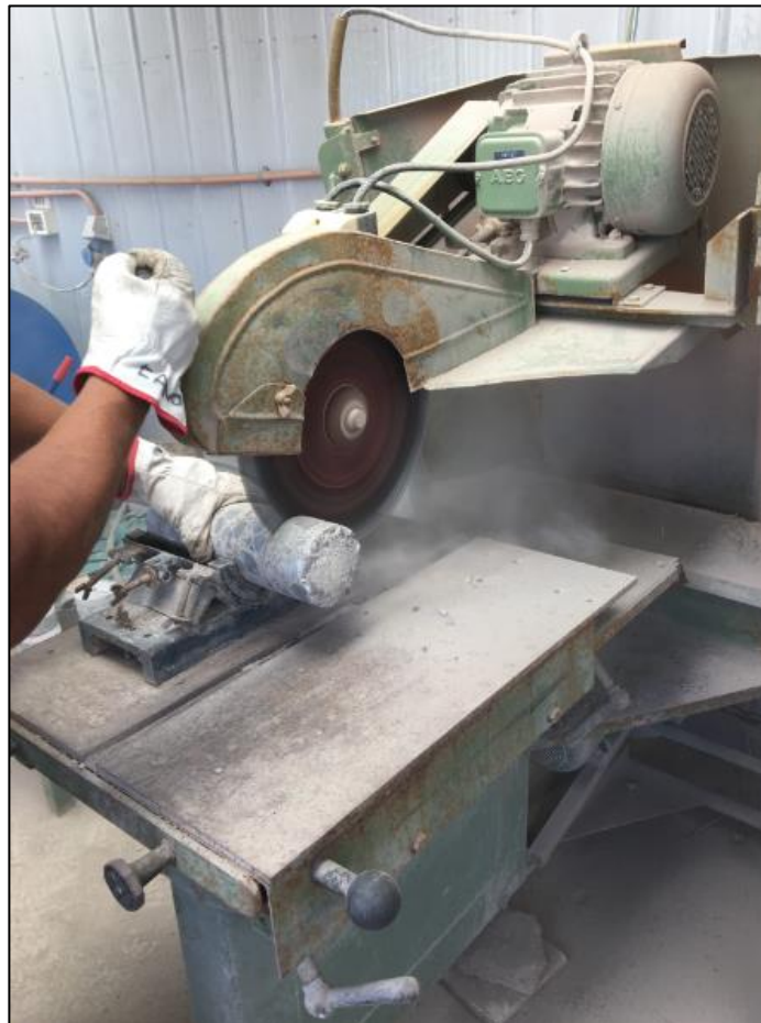
Figura 13: Corte de núcleos de hormigón [elaboración propia].
