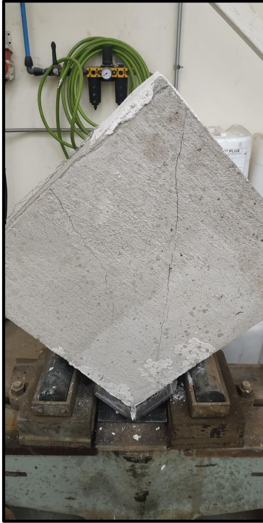
Figura 51: Grietas en la diagonal del murete de eco-ladrillos en disposición vertical.
