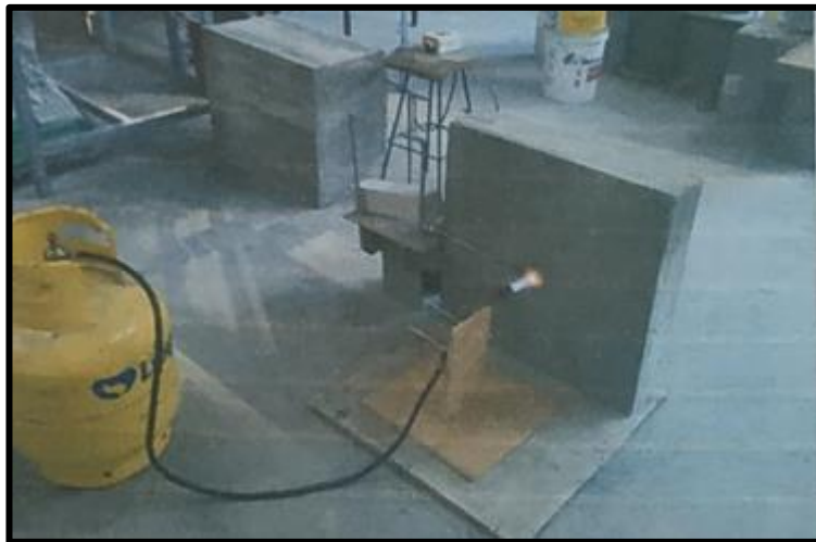
Figura 70: Ensayo a llama directa en panel de eco-ladrillos en disposición vertical.
