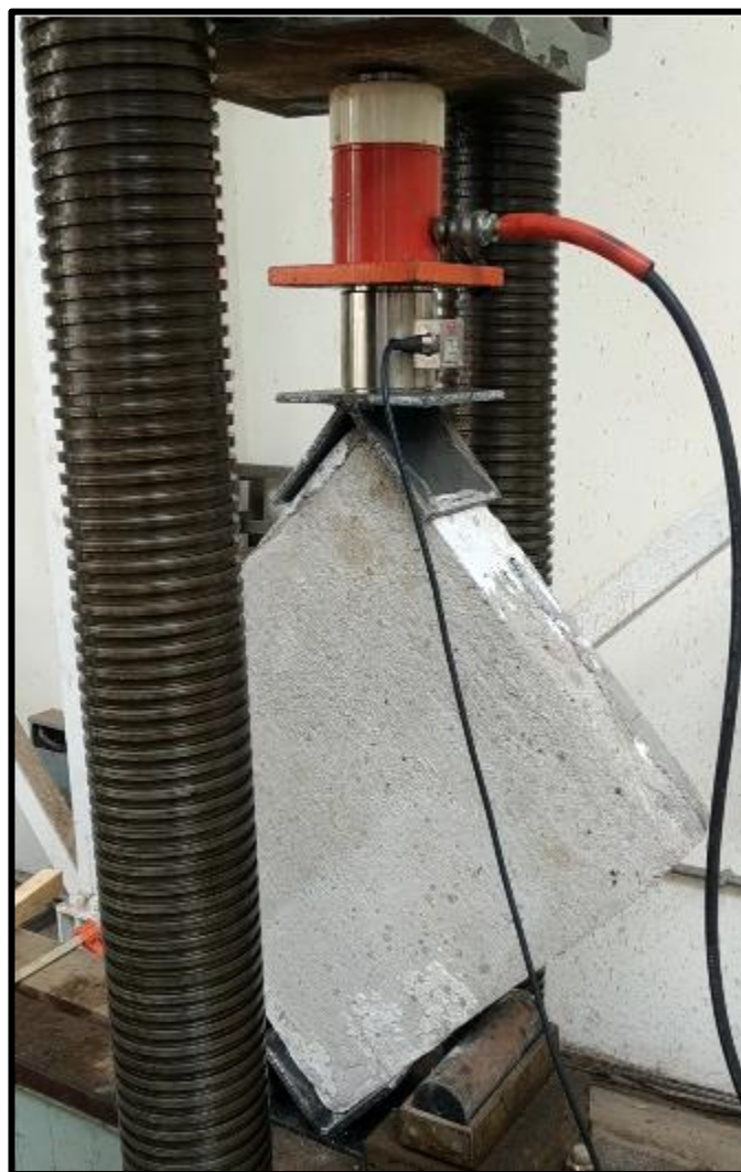
Figura 49: Murete eco-ladrillos en disposición vertical para ser ensayado.
