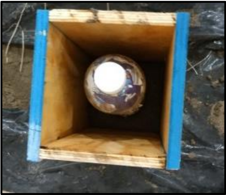
Figura 20: Fabricación de una unidad de albañilería de eco-ladrillo. Fuente: Elaboración propia, 2019.
