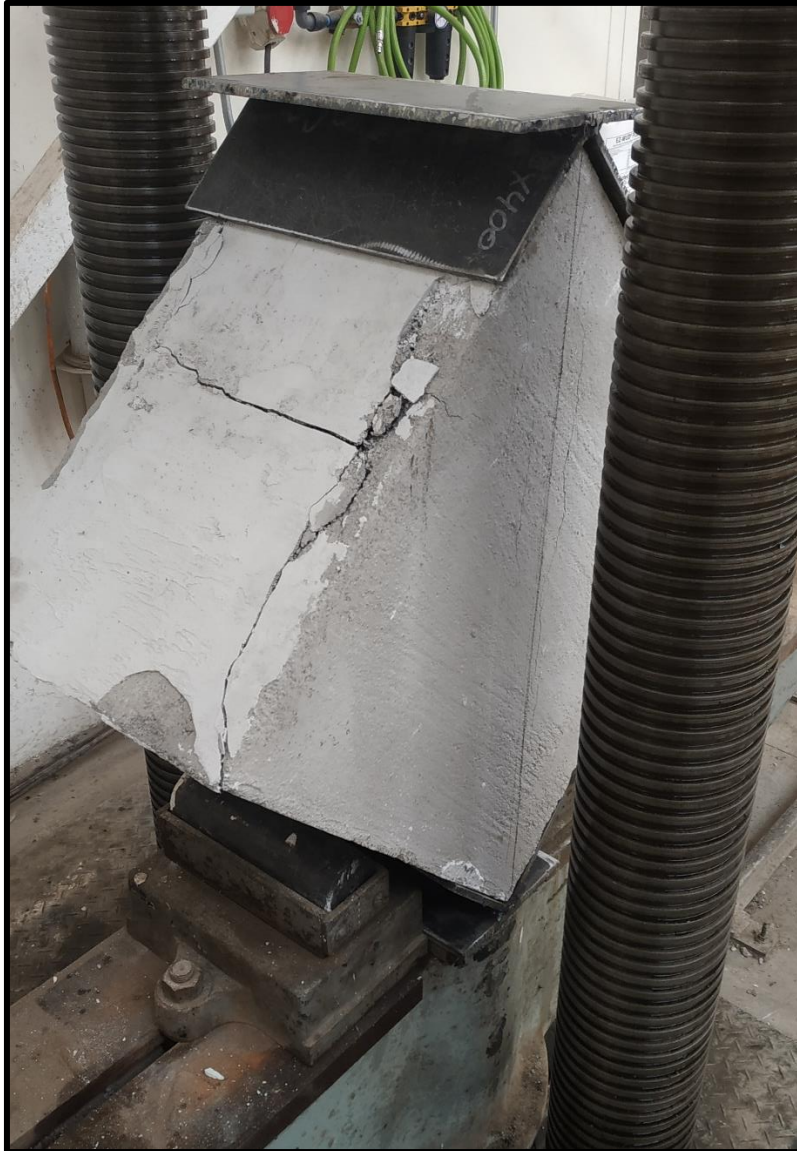
Figura 47: Grietas en la arista de murete de eco-ladrillos en disposición horizontal.
