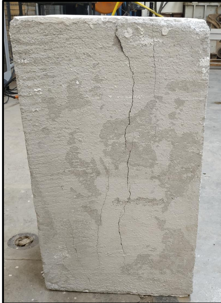
Figura 55: Grietas en prisma de eco-ladrillos en disposición horizontal.
