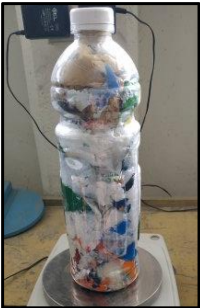
Figura 11: Eco-ladrillo mediano fabricado.
