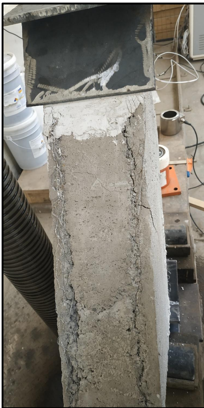
Figura 52: Grietas en la arista del murete de eco-ladrillos en disposición vertical.
