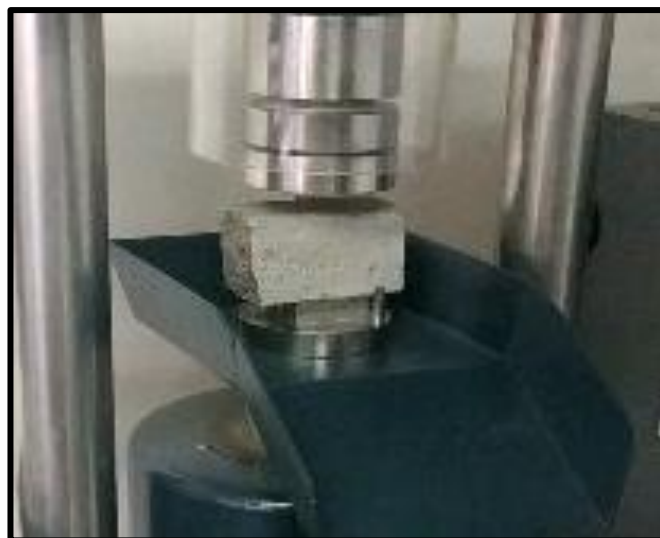
Figura 17: Ensayo de compresión de probetas de mortero.
