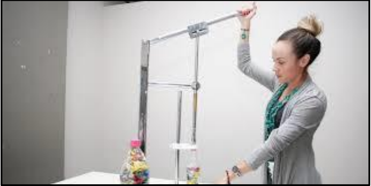
Figura 10: Compactador mecánico de residuos para elaboración de eco-ladrillos.
