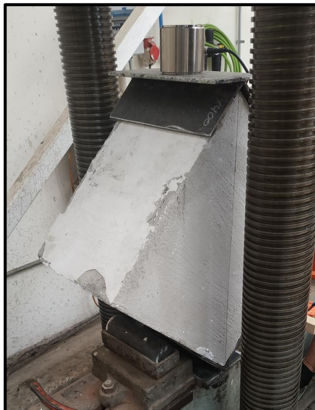
Figura 45: Murete eco-ladrillos en disposición horizontal para ser ensayado.
