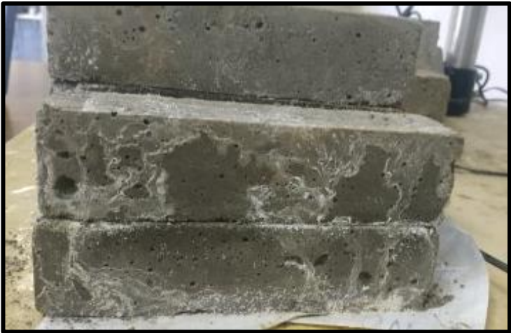
Figura 35: Anomalía en probeta de mortero de estuco interior.
