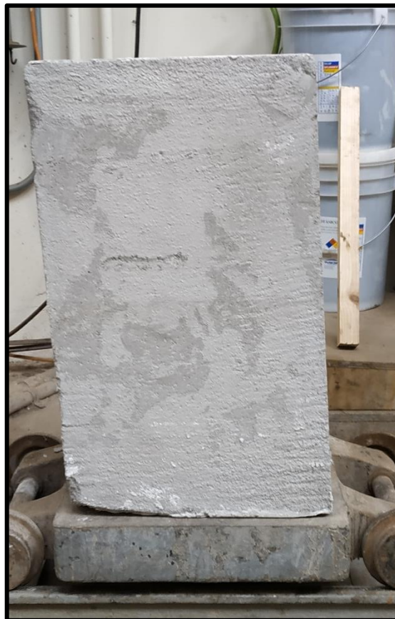
Figura 53: Prisma de eco-ladrillos en disposición horizontal para ser ensayado.
