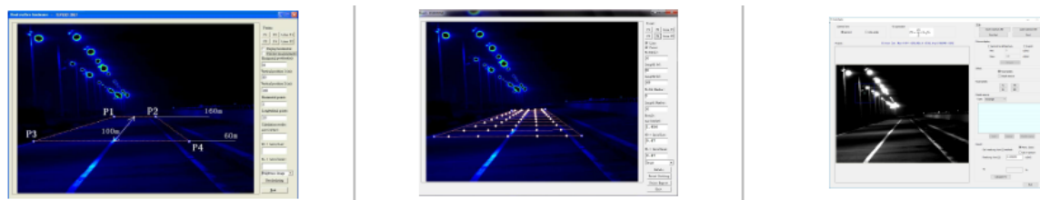
Figura 1.11: Medición de luminancia en todos los puntos de la retícula, cálculo de incremento de umbral.
