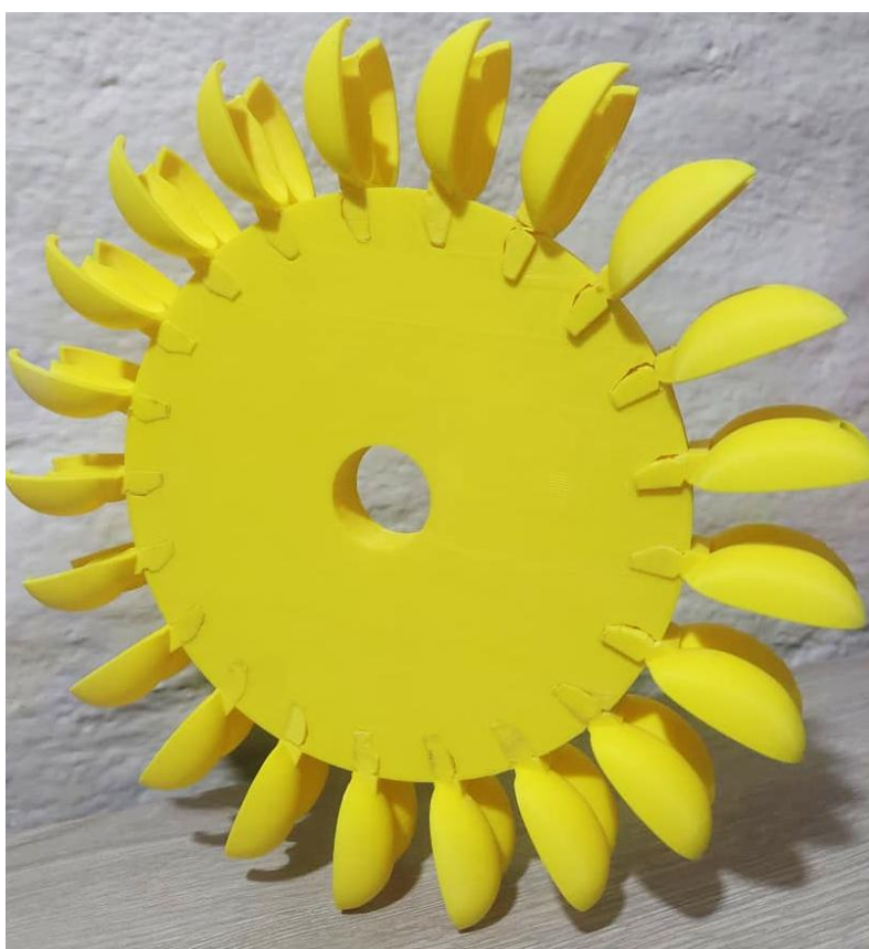
Figura 7.10: Fotografía del ensamblaje de las cucharas al disco central del rodete de la turbina Pelton. Fuente: elaboración propia.
