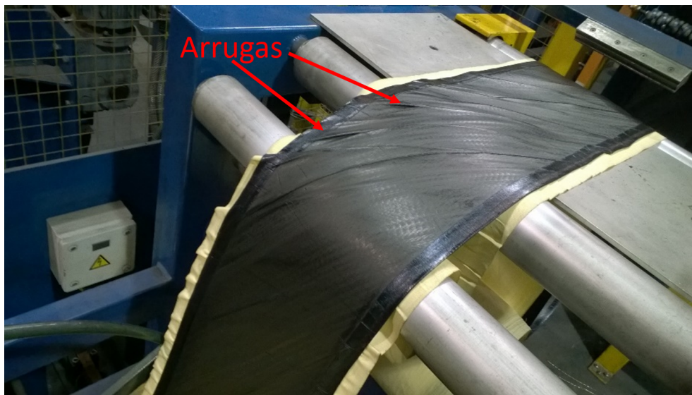
Figura 6.2: Arruga de Breaker presentada en el desenrollado en maquina HF.
