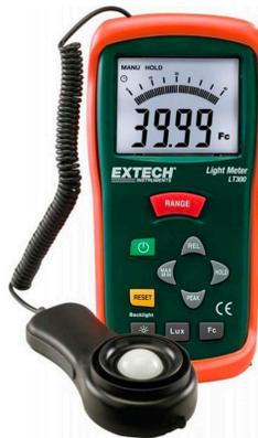
**Imagen 11:** Luxómetro, sistema de medición de la iluminancia
