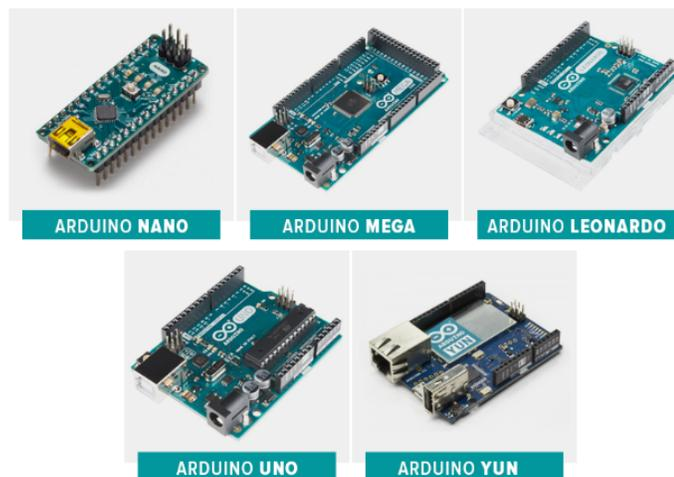
**Imagen 16:** Distintos modelos de placas Arduino
