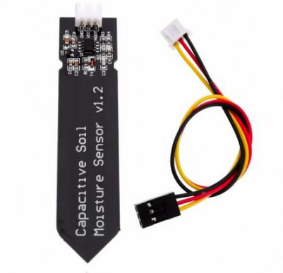
**Imagen 26:** Sensor Capacitivo de humedad de suelo v1.2
