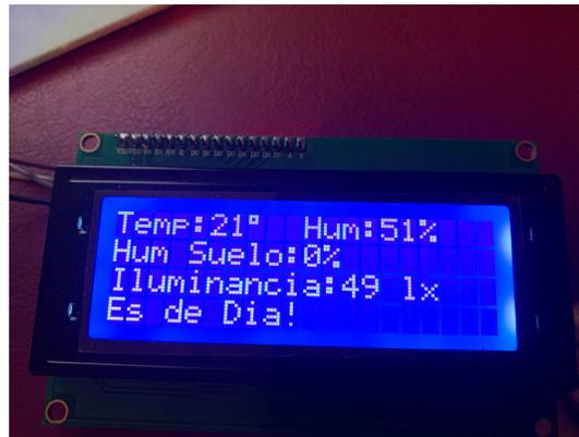
**Imagen 62:** LCD: Estado de condiciones medioambientales iniciales
