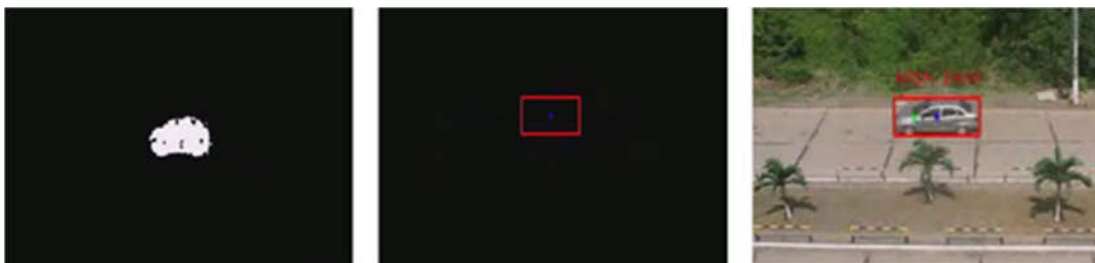
Figura 7-10: Izq.: Imagen resultante de la segmentación. Centro: Imagen resultante de la caja englobante. Der.: Imagen original con caja englobante.
