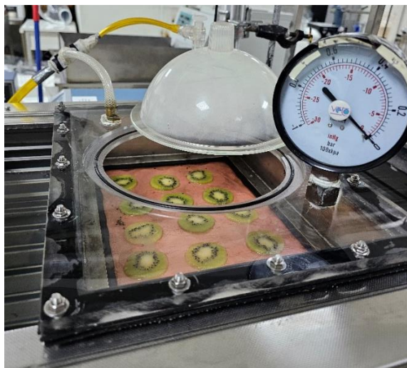
Figura 13 Estructura para SHCV utilizando lámina de cobre como soporte
