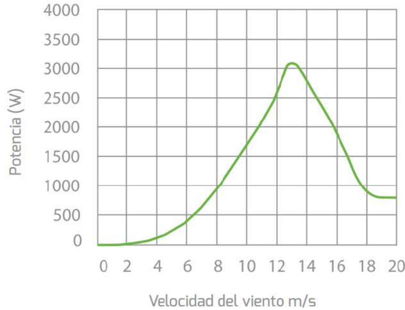
Figura 4.3: Curva de potencia del aerogenerador comercial seleccionado de 3.000 W (Bornay, 2020).
