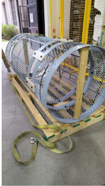
Figura 3.10: Jaula Corona recién construida (Elaboración propia).
