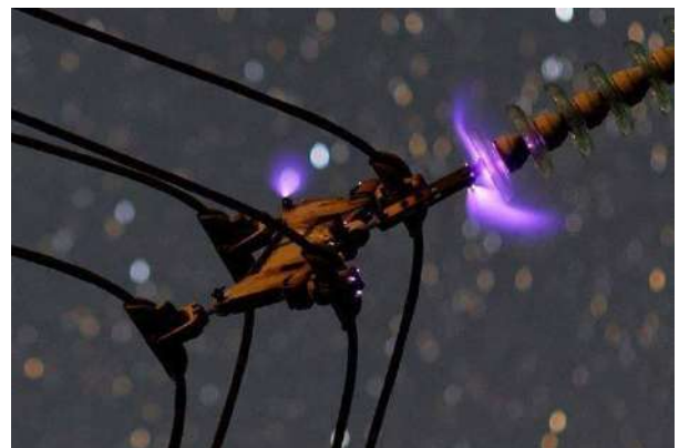
Figura 1.3: Efecto corona en aisladores [5].
