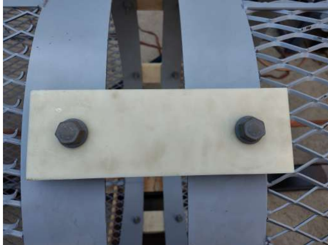
Figura 4.8: Unión hecha de el material aislante TECHNYL.
