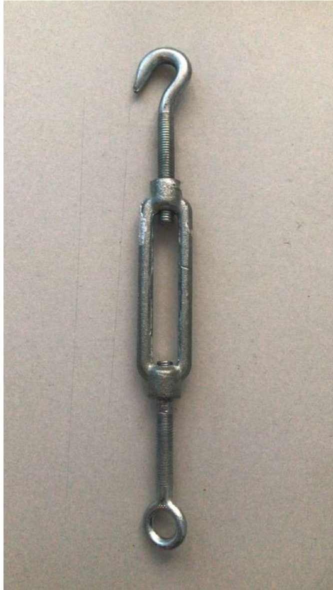
Figura 7.5: Tensor ocupado durante los ensayos
