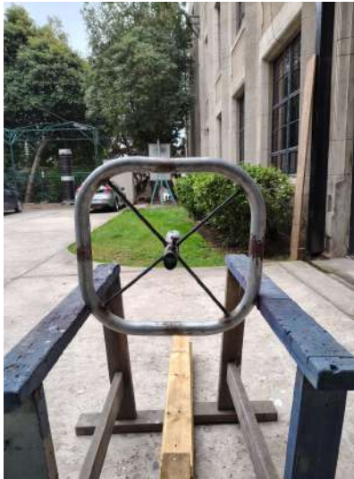
Figura 4.4: Anillo corona ocupado durante los ensayos.
