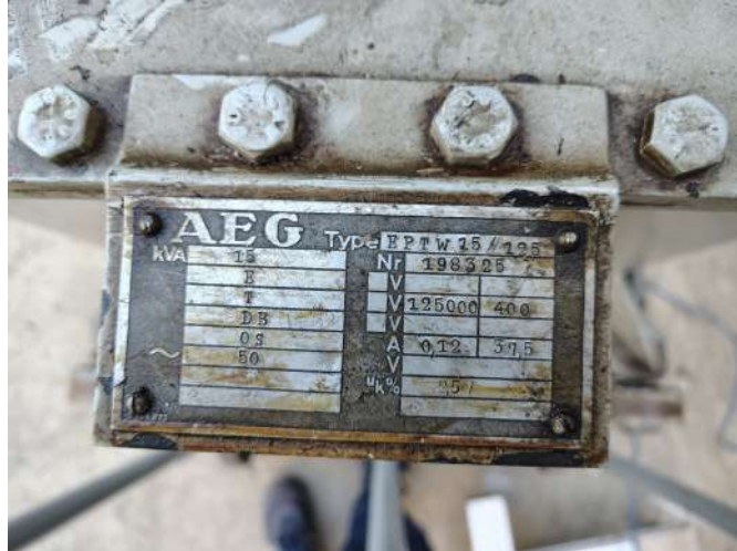
Figura 7.9: Placa del transformador AEG utilizado en las pruebas.
