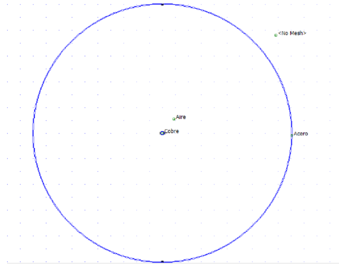
Figura 3.2: Vista de un corte transversal del sector de medición de la jaula corona (Elaboración propia).
