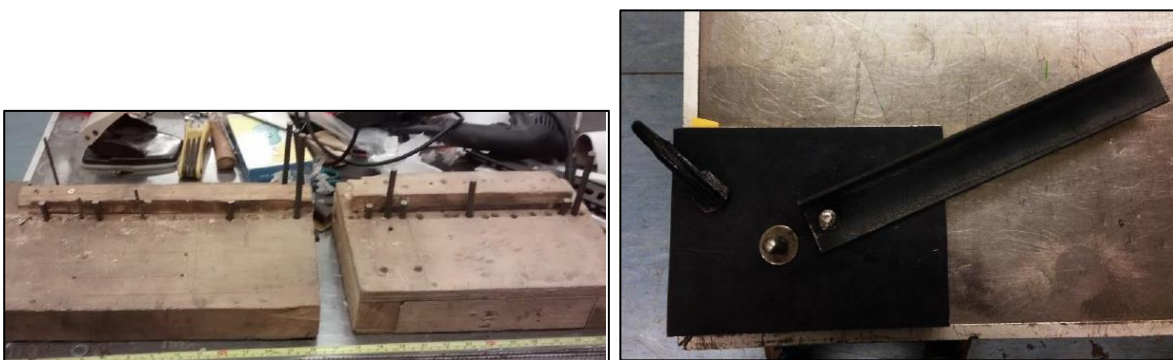
Figura 28. Machina utilizada para la confección de estribos Pino (2016) (izquierda) y machina utilizada para la confección de estribos en la presente memoria (derecha)
