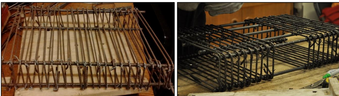
Figura 27. Armadura de columna utilizada en memorias anteriores (izquierda) y armadura de columna utilizada en esta memoria (derecha).
