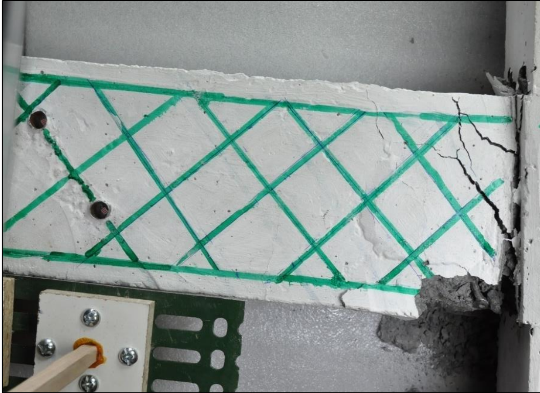
Figura 37. G.F.1. Cuarto ciclo, amplitud 25 [mm]. (Máximo desplazamiento positivo)
