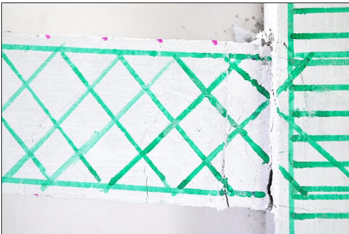
Figura 51. P.1. Quinto ciclo. Amplitud 25 [mm]. (Máximo desplazamiento positivo)
