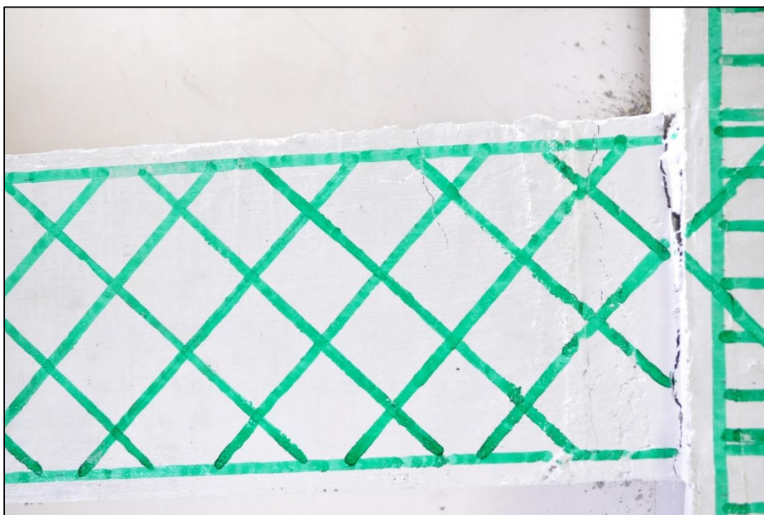
Figura 59. P.2. Quinto ciclo. Amplitud 25 [mm]. (Máximo desplazamiento negativo).
