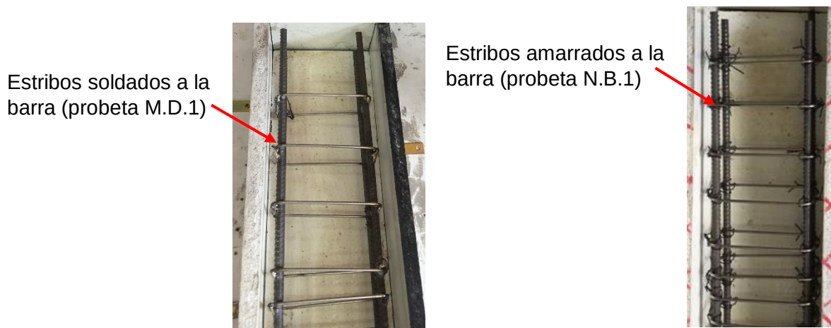
Figura 20. Algunas características de las probetas M.D.1 y N.B.1
