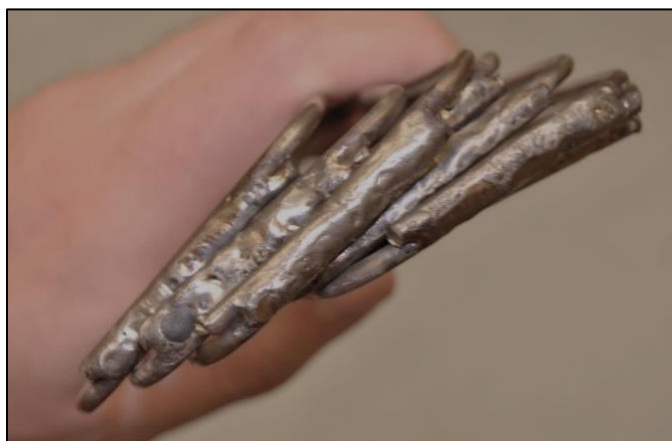
Figura 9. Estribos de acero inoxidable soldados con cerco continuo
