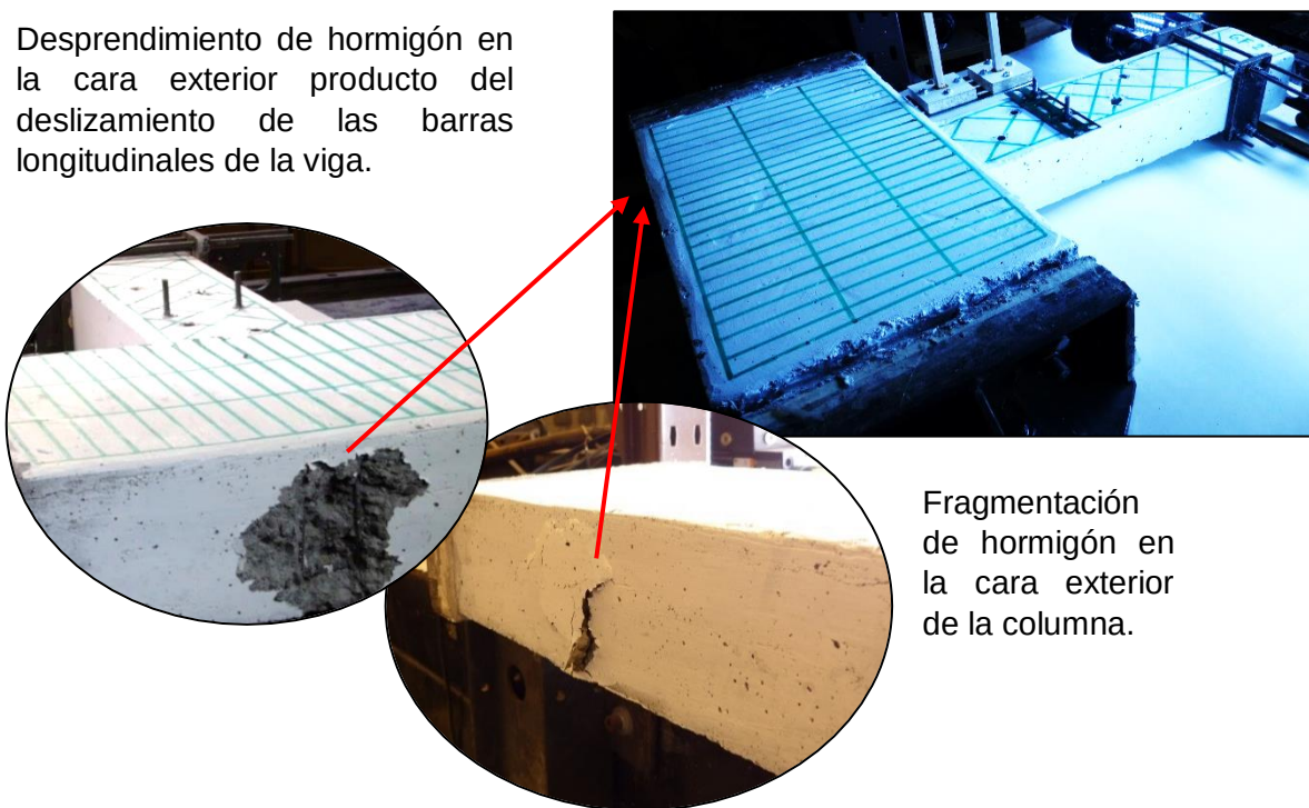
Figura 47. G.F.2. Estado del espécimen cerca del término del ensayo.
