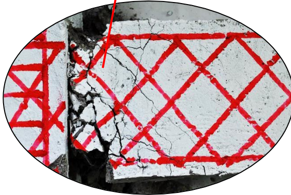
Figura 80. C.B.1. Estado final de la probeta al finalizar los ciclos de 25 [mm]
