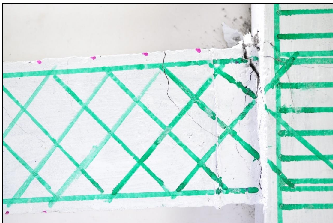
Figura 52. P.1. Quinto ciclo. Amplitud 25 [mm]. (Máximo desplazamiento negativo)
