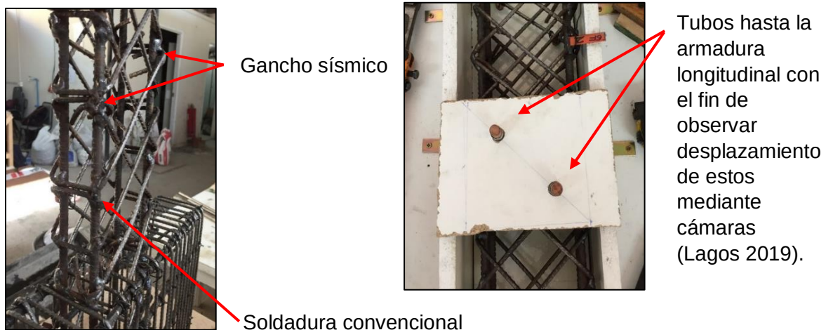
Figura 12. Algunas características de las probetas G.F.1 y G.F.2.
