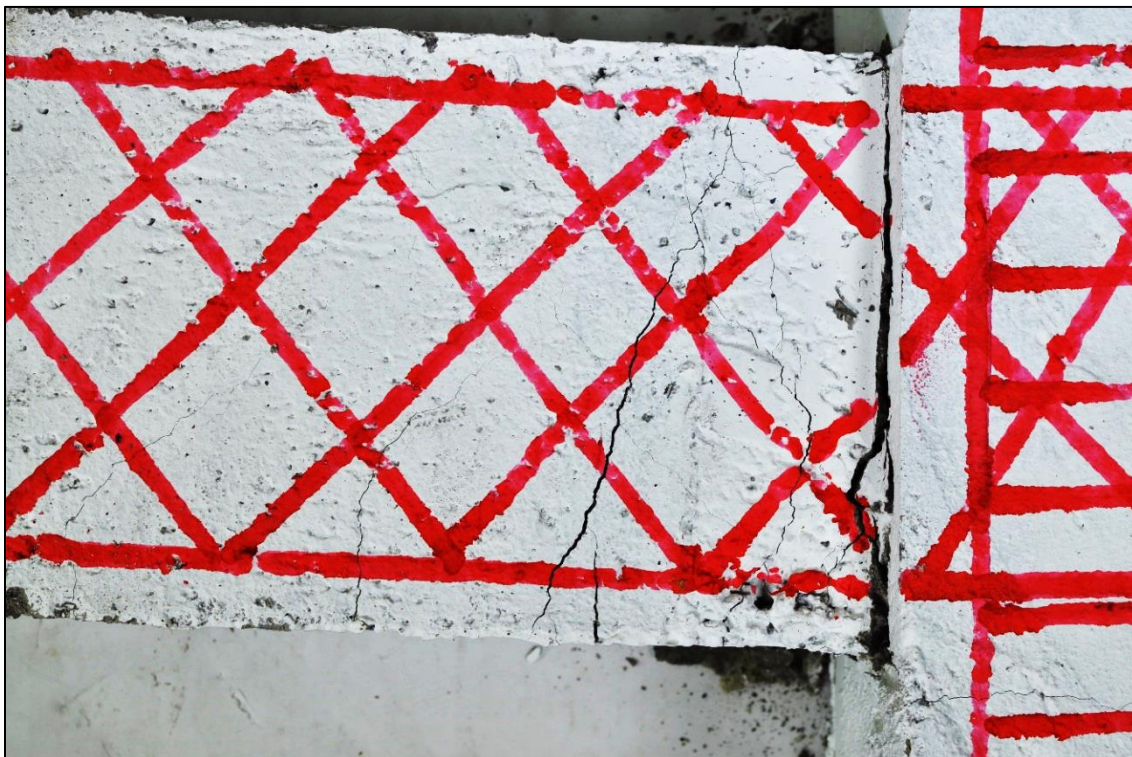
Figura 78. C.B.1. Quinto ciclo. Amplitud 25 [mm]. (Máximo desplazamiento positivo).
