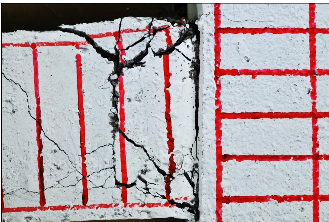
Figura 85. M.D.1. Quinto ciclo. Amplitud 25 [mm]. Máximo desplazamiento negativo).
