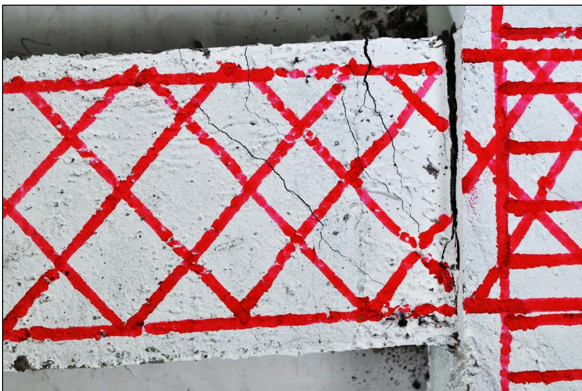
Figura 79. C.B.1. Quinto ciclo. Amplitud 25 [mm]. (Máximo desplazamiento negativo).
