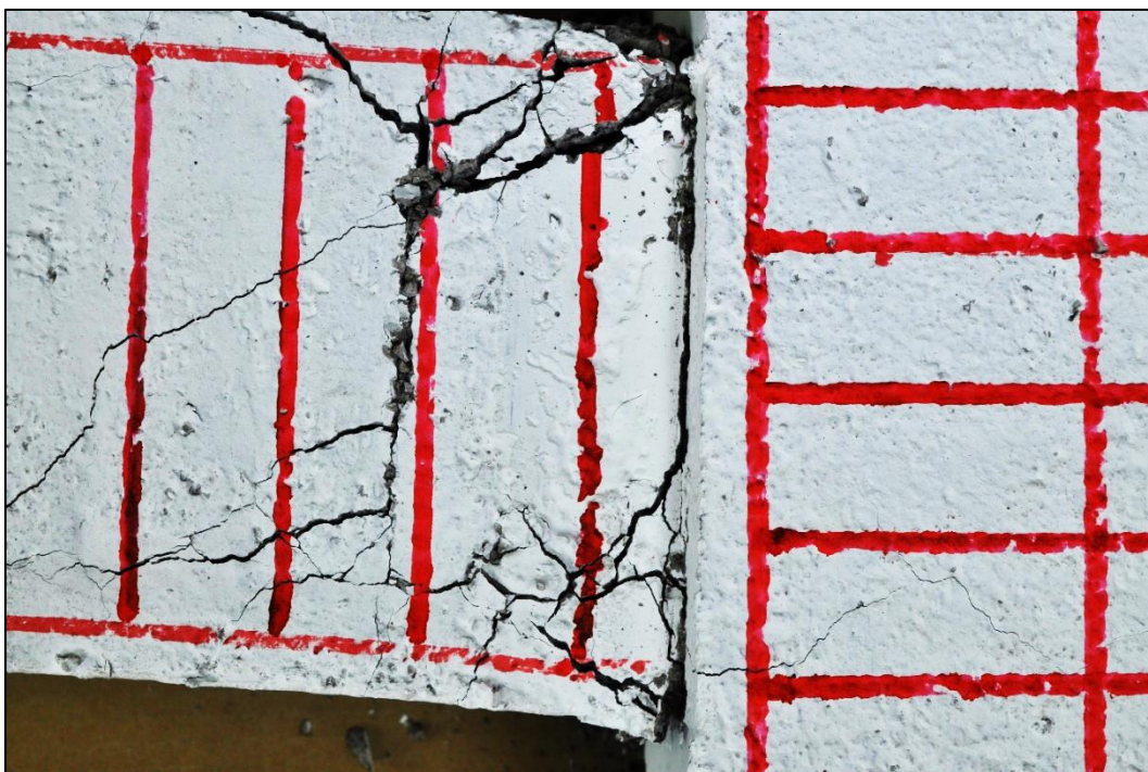
Figura 84. M.D.1. Quinto ciclo. Amplitud 25 [mm]. (Máximo desplazamiento positivo).
