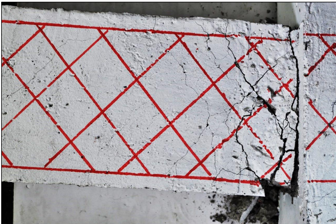
Figura 64. E.B.1. Cuarto ciclo. Amplitud 25 [mm]. (Máximo desplazamiento positivo)
