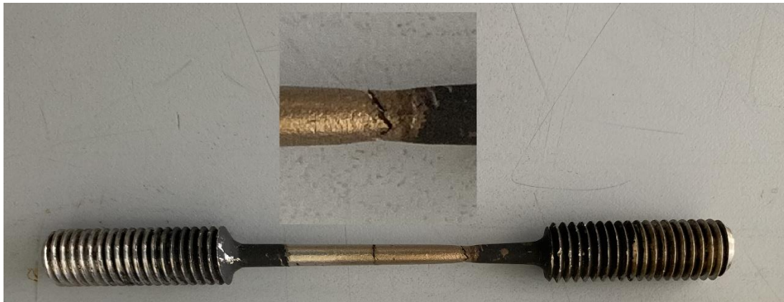
Figura 4.3.26 Probeta con formación de cuello.
