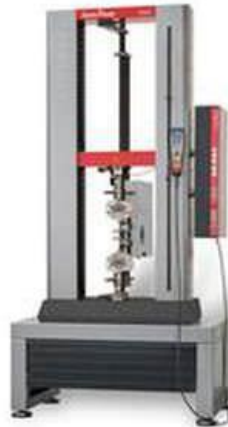
Figura 3.2.2 Máquina de tracción Zwick Roell Z030 [33].
