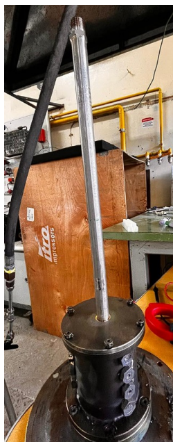
Figura 32: Arreglo para solucionar fundido de cañerías
