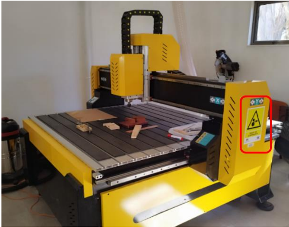
Fotografía N° 73: señalética de seguridad y advertencia ROUTER CNC 1325 GIOVICNC
