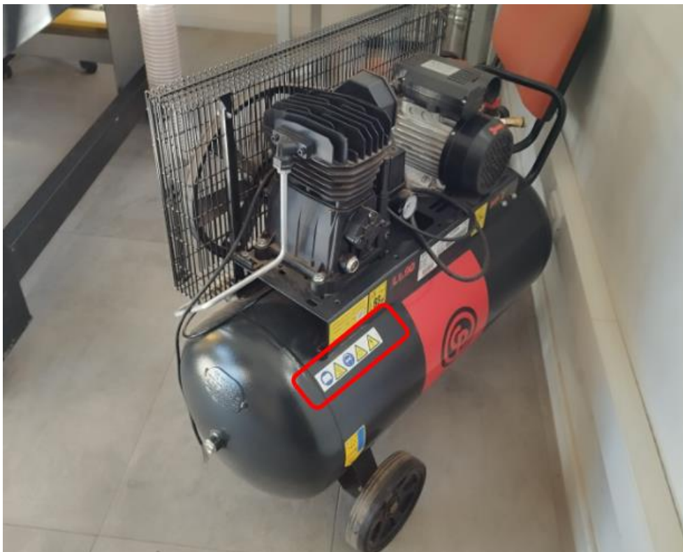
Fotografía N° 72: señalética de seguridad y advertencia, compresor de aire
