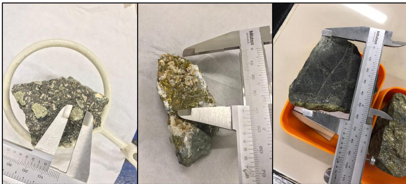
Figura 4-5: Roca Muestrario Laboratorio ICMIN de UTFSM, (a) Andesita de Textura Porfídica, (b) Muestra N°1 Mayor Cristalización del Mineral acompañado de una matriz cuarcífera, y (c) Muestra N°2 Matriz de Andesita con Textura Afánítica, Calcopirita Oxidada por Aire y Presencia de Vetillas.
