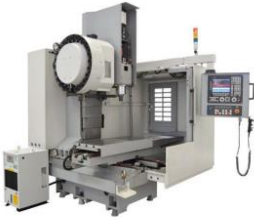
Ilustración 3:"Centro de mecanizado con control FAGOR"
