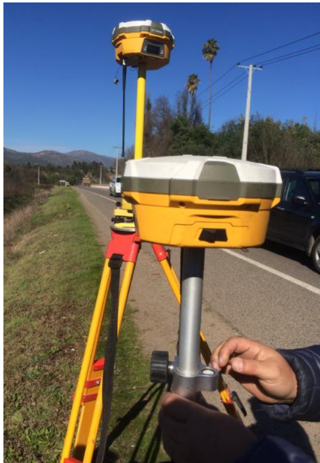
Figura 2-2. Base instalada y 2° GPS geodésico.
