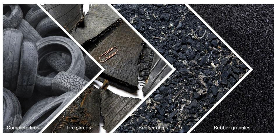
Figura 2.3: Proceso de reciclaje de neumáticos [13]
