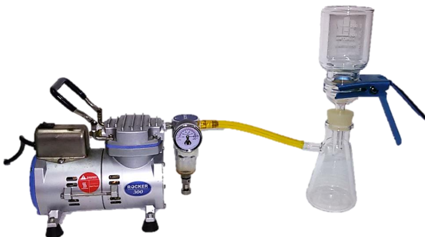
Figura 22. Sistema de filtración
