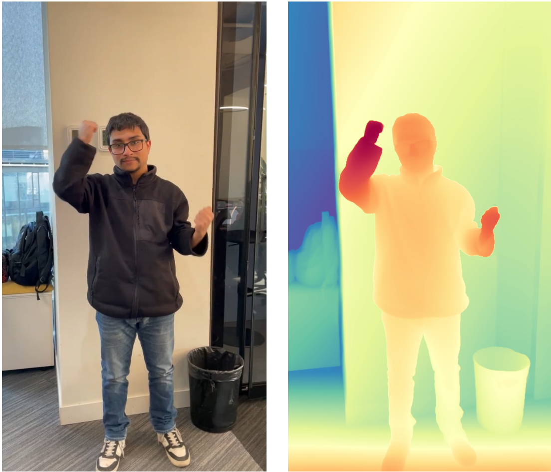
Figura 8.9: Izquierda: cuadro RGB del video. Derecha: mapa de profundidad relativa estimado con Depth Anything V2 y normalizado para análisis y visualización.
